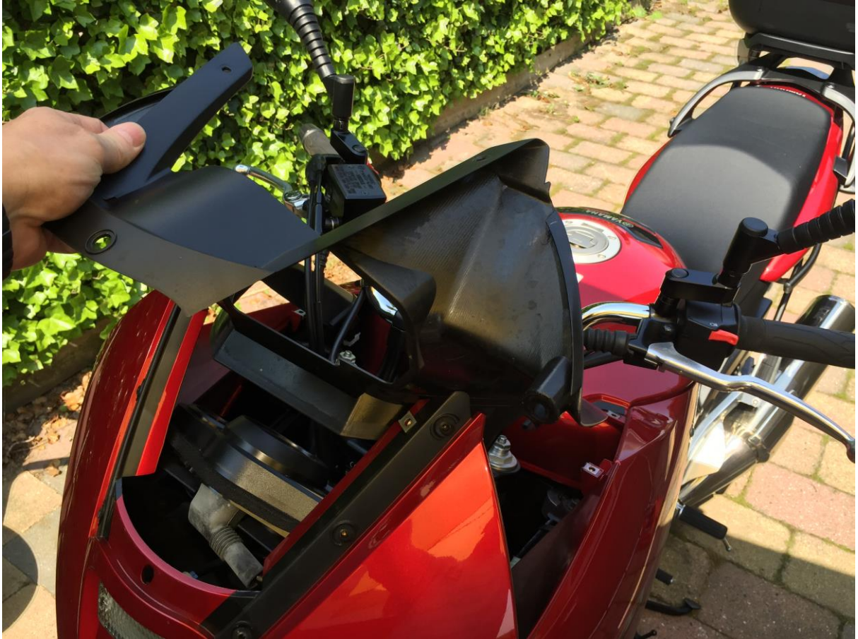
Demontage kap achter ruit 2
