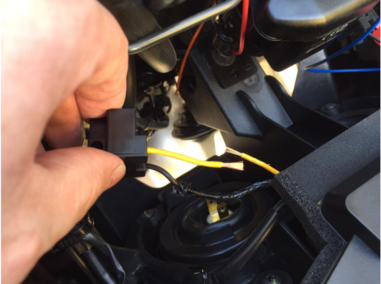
Aansluiten doorgeknijpte eindjes van de plusdraad van grootlicht (geel) op 3 en 4 van de module
